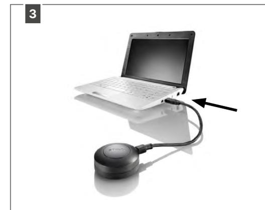
Collega lo strumento di installazione Set&Go al tuo PC Windows tramite il cavo USB in dotazione.
